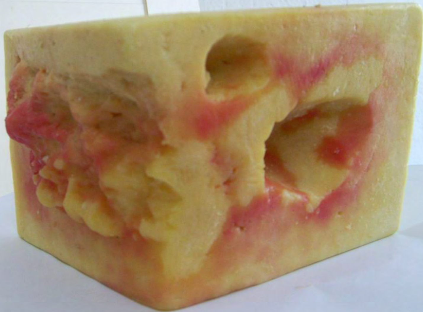
Manchas causadas por excesso de Nitratos na massa
